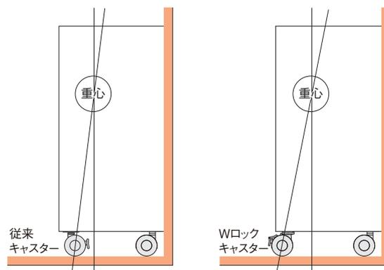
重心位置が高い搭載物において、従来のキャスターで図のように接地してしまうと前方向へ倒れやすくなります。これをWロックキャスターで一方からしかロックできないようにすることで設置状態でのキャスターの向きが一定になり、不慮の事故を防ぐことができます。
