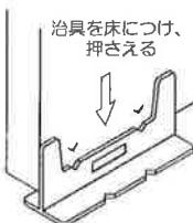
3. 扉を元に戻し、受のビス位置2ヵ所をけがきます。けがいた印の三角の頂点をキリモミなどしてビスを止めてください。
