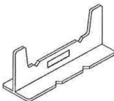
1. 扉の端と治具の端を合わせ、下端も密着させます。鉛筆などで本体のビス位置2ヵ所をけがきます。
