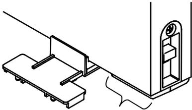
扉底面から出ている本体部分を選けた場所に付属の取付治具をゆっくり押し当てて扉と床の距離を確認します。
