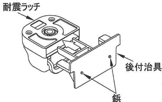
2 標準取付位置の天板前部に治具を図のように当て所定のネジで固定してください。
