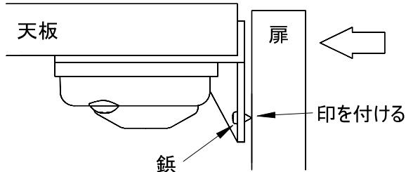
4 鉢で印を付けた位置に所定のネジで受の長穴中央で仮固定してください。
