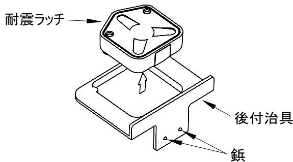
2 標準取付位置の天板前部に治具を図のように当て所定のネジで固定してください。
