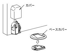
5 完成後、適正に作動するか確認してください。 扉を開けてドアストッパーの位置までもってくると ベースが作動し、扉がロックされる事を確認してください。 その後、カバーを上から押しロックが解除される事を 確認してください。
